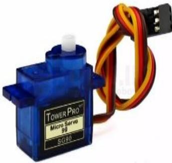
Gambar 2. Motor Servo SG90
