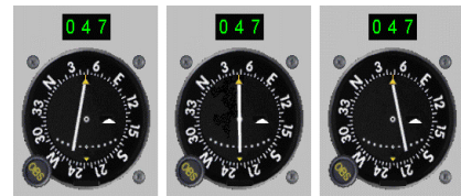
Gambar instrument Localizer yang ada di cockpit pesawat
